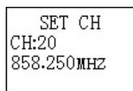
Durch Drücken der Tasten + bzw. - können Sie den Kanal ändern. Bestätigen Sie die Eingabe abschließend durch Drücken der **SET**-Taste.
