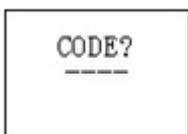
Zunächst wird ein CODE abgefragt. Werkseitig ist der Code ++++ eingestellt. Drücken Sie daher **vier Mal die Taste +** und bestätigen Sie die Eingabe mit der **SET**-Taste
